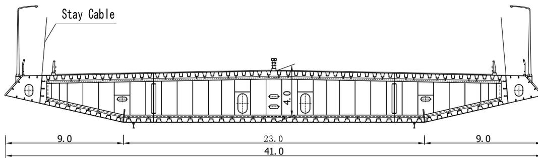
FIGURE 7 – CROSS SECTION OF THE GIRDER (UNIT: M)
