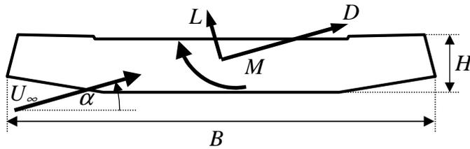
FIGURE 2 - DEFINITION OF AERODYNAMIC FORCES AND WIND DIRECTION
