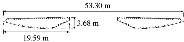
FIGURE 3 - TWIN GIRDER SYSTEM OF STONECUTTERS BRIDGE
